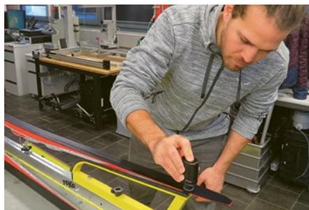
Un chercheur du SLF applique le lubrifiant à base de pigments colorés sur les skis de test.
